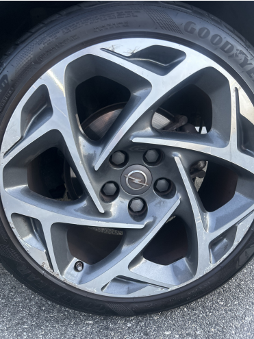
F5 | Kolesá a brzdy Poškodenie kolies a diskov
